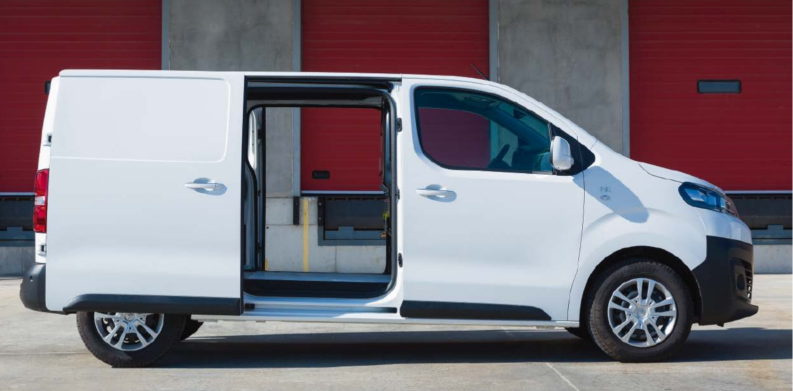
En este Jumpy de talla M, el ancho de las puertas laterales supera los 93 cm, para facilitar la carga de un europallet.
